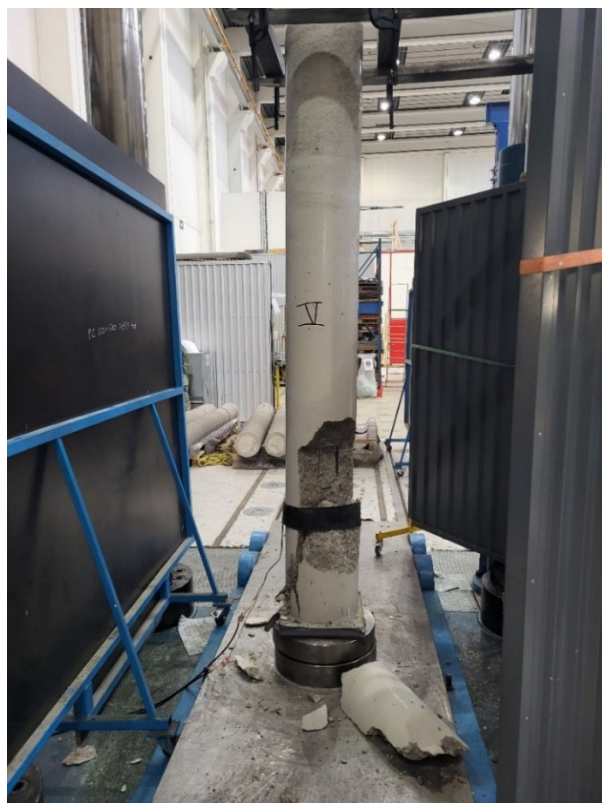
Figur 23: Pelare V efter brott. Notera att brottet skedde i botten av provkroppen.
