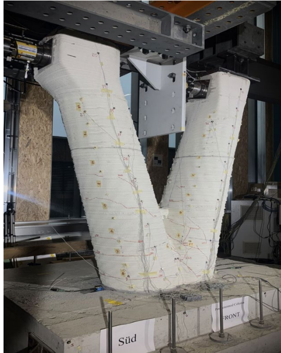
Figur 3: Provning av 3D-utskrivna betongpelare för Tor Alva. https://www.linkedin.com/posts/kfmresearch_kfmresearch-dfab-reinforcedconcrete-ugcPost-7166718967527505920-uA2Y?utm_source=share&utm_medium=member_ios
