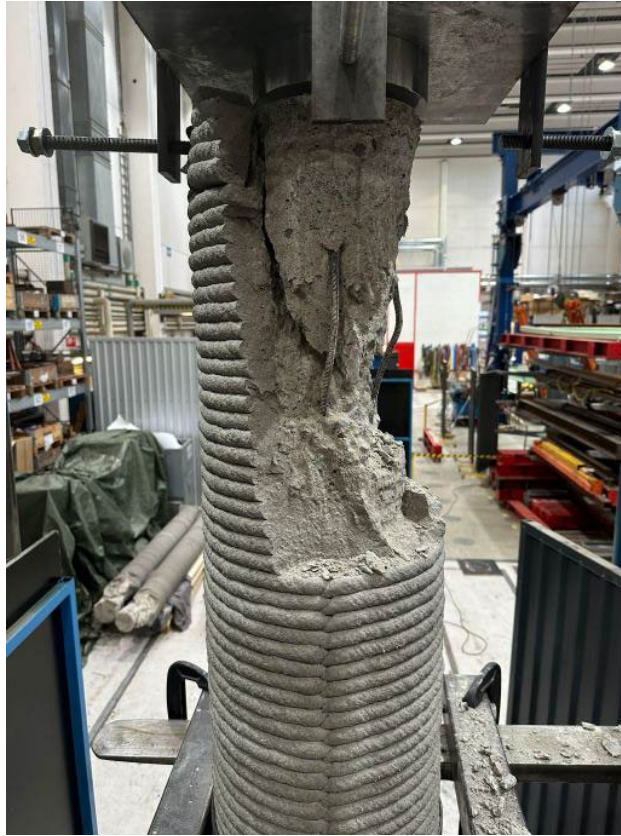
Figur 40: Pelare III efter brott (Al-Bazarkan & Alahmad, 2024).
