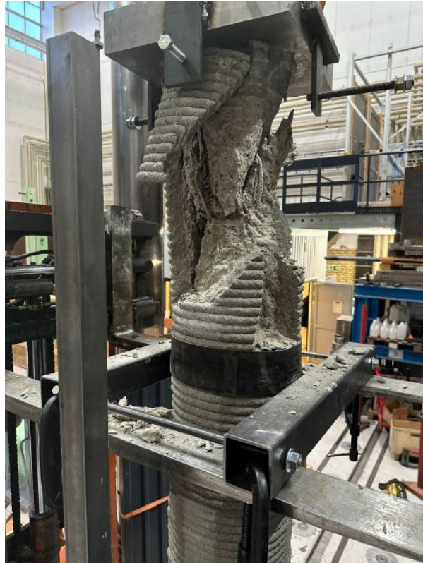
Figur 38: Pelare I efter brott (Al-Bazarkan & Alahmad, 2024).
