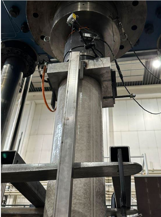
Figur 15: Lastcellens placering då hela övre tvärsnittet av pelaren belastades (t.v.) resp. då enbart en inre del av tvärsnittet belastades (Al-Bazarkan & Alahmad, 2024).
