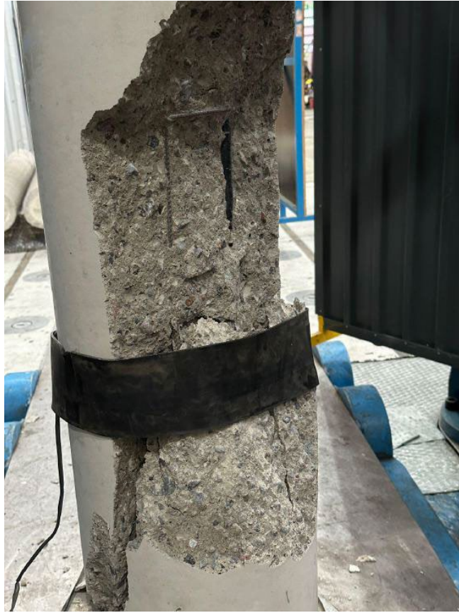
Figur 42: Pelare V efter brott (Al-Bazarkan & Alahmad, 2024).
