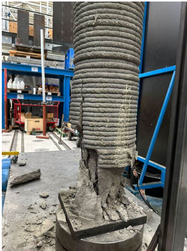
Figur 41: Pelare IV efter brott (Al-Bazarkan & Alahmad, 2024).
