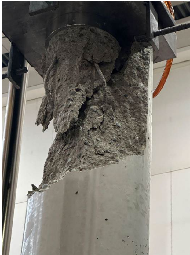
Figur 43: Pelare VI efter brott (Al-Bazarkan & Alahmad, 2024).
