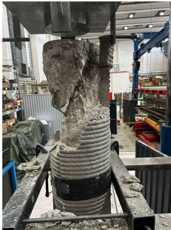
Figur 39: Pelare II efter brott (Al-Bazarkan & Alahmad, 2024).
