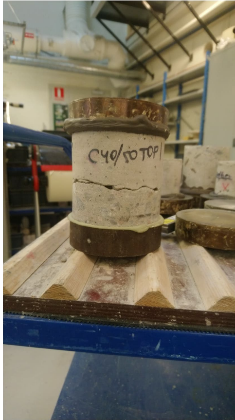
Figur 6: Vidhäftningsprov för kärna genom övre delen av provkroppen med 3D-utskrivna betong och vibrerad betong C40/50. (Boned Ferrer, 2021).
